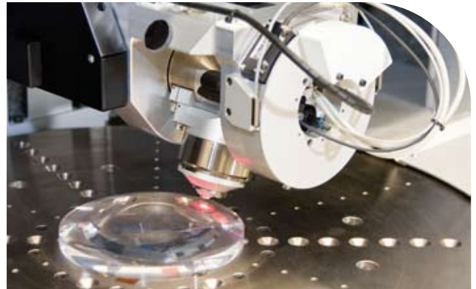
Het opmeten van een bolle lens. Hier is duidelijk te zien dat de sensor, om loodrecht op het lensoppervlak te kunnen meten, onder een hoek staat
