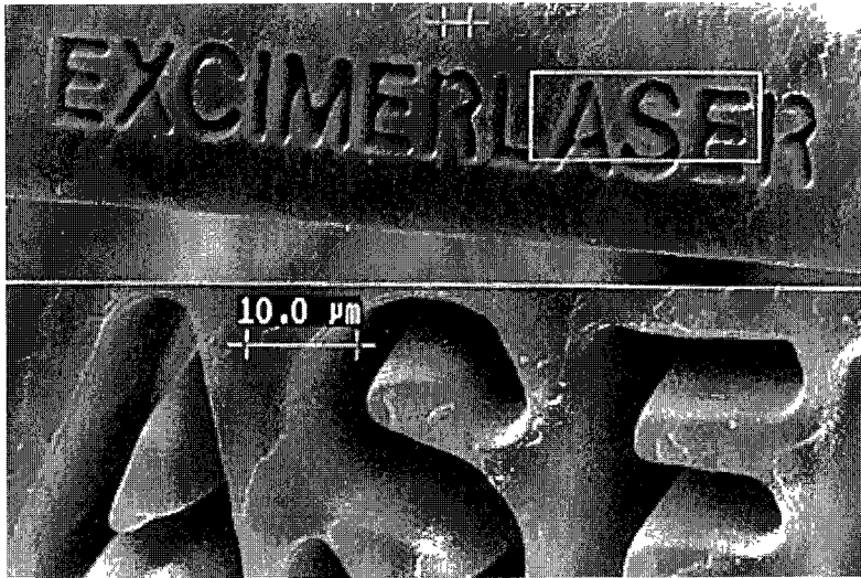
Figuur 3 Demonstratie van de mogelijkheden van de excimeerlaser in de fijn- en micromateriaalbewerking een menselijke haar, door de excimeerlaser voorzien van tekst (Afbelding Lambda Physik)
