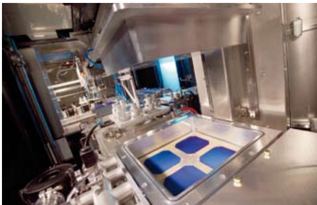
Afbeelding 3. Een van de stations in een DEP x -machine. De laag Si 3 N 4 die via het PECVD-proces is gedeponerd, heeft de vier Si-plakken blauw gekleurd.
