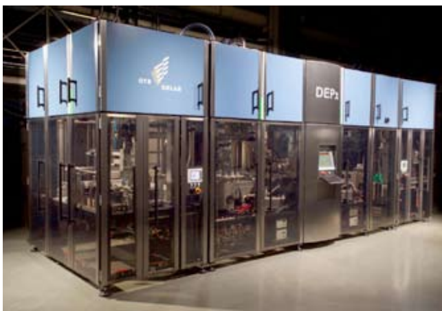
Afbeelding 2. De DEP x 1500 brengt een antireflectielaag van siliciumnitride aan op zonnecellen.
