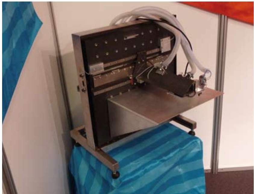
Afbeelding 2. Zogeheten HUniplacers, ontwikkeld vanuit de 'HUniversal Production' filosofie als de meest laagdrempelige toegang tot geautomatiseerde en productspecifieke assemblage in het middenvolume-segment (circa 10^4 tot 10^6 producten/jaar).
