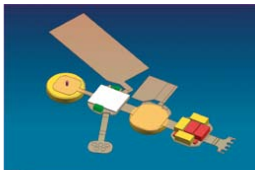
Afbeelding 5. De complete elektronica inclusief microprocessor en transceiver op flexprint. Rechts en linksonder de antennes.
