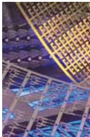
Afbeelding 10. Enkele voorbeelden van geëtsde producten van PGE-Adenco.
