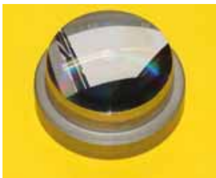
Afbeelding 7. Een met gereedschapexcitatie bewerkte matrijs-inzetstuk met optische oppervlaktekwaliteit.
