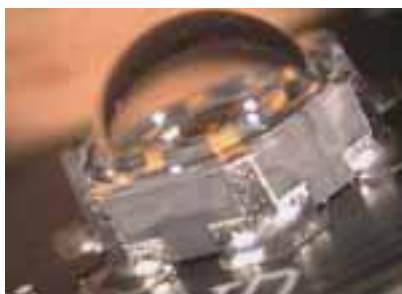
Afbeelding 6. Een LED-voet als voorbeeld van een geslaagde Moulded Interconnected Device die wat betreft de temperatuurhuishouding is geoptimaliseerd.
