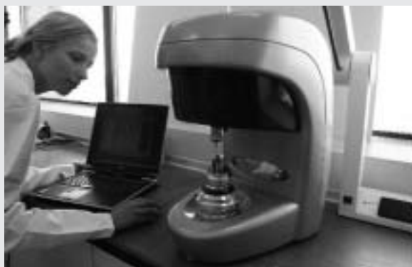
Afbeelding 2. Speciale scanner ontwikkeld ten behoeve van tandtechnologie.
