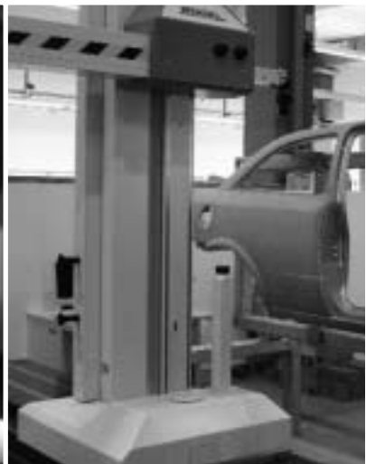
Afbeelding 11. Een staandermeetmachine voor het meten van autobody's.
