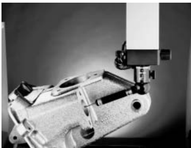
Afbeelding 4. De tasterkop MH20, geschikt voor kleinere en handbediende coördinatenmeetmachines. Door de handmatige instelmogelijkheid kan de gebruiker de systemen in uiteenlopende posities toepassen. De zeer compacte tasterkop biedt veelzijdige meetfuncties met iedere combinatie van draaiing en hoek en is voorzien van een specifiek borgingsmechanisme.
