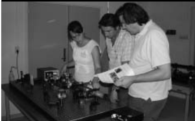
Afbeelding 3. Uitlijnen van een interferometeropstelling.
