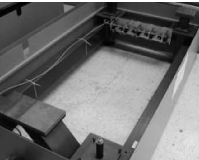
Afbeelding 9. Een onderframe met drie rubberdempers waarop de basisplaat rust.
