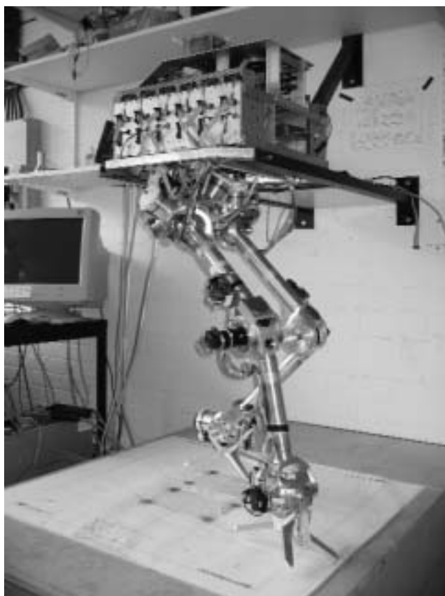
Afbeelding 2. Tweede-generatie tweebeugelige looprobot, met gewrichten die ook zijwaartse verstoringen kunnen compenseren.
