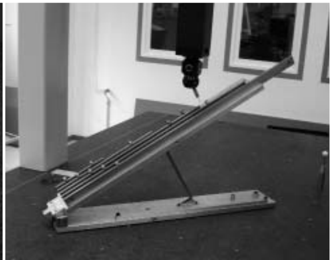
Afbeelding 13. Kalibratie van een meetmachine met Koba meetstandaarden.
