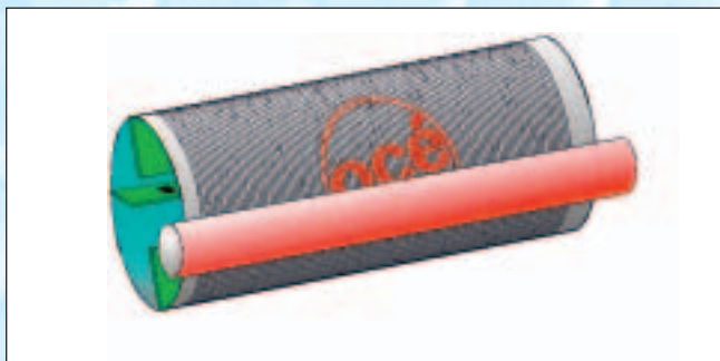
Figuur 1. Schets van de Direct Imaging Drum met circa 7600 sporen. De aansturelektronica zit op vier arrays.
