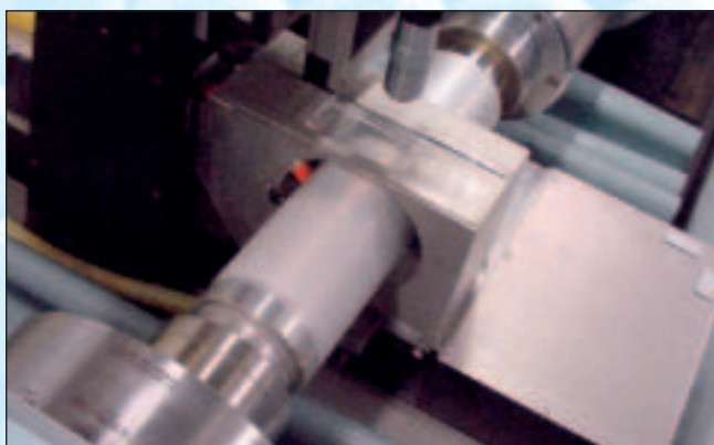
Figuur 8. Opname in de precisiedraaibank tijdens het groeven steken.
