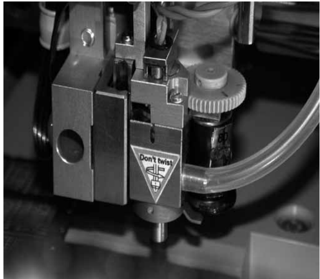
Afbeelding 8. De Rotary Bond Tool met een Micro Harmonic Drive® voor de uiterst nauwkeurige hoekpositionering van chips
