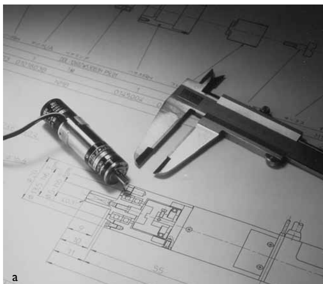
Afbeelding 1a en b. Foto en tekening van een Harmonic Drive type HDUC-5 met een buitendiameter van 20 mm
