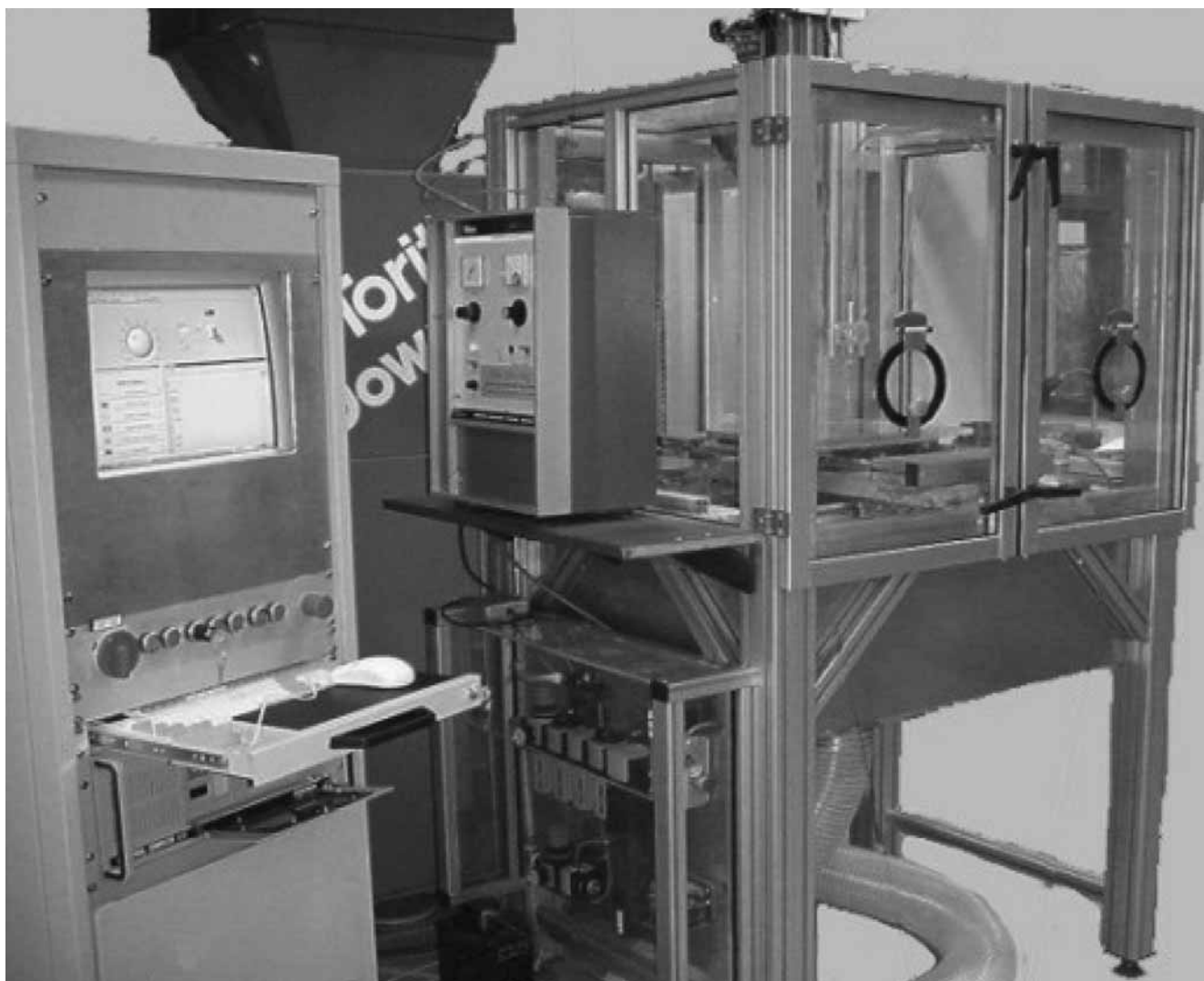
Afbeelding 3. Een experimentele opstelling van PTO TU Delft voor microbewerking met een abrasieve luchtstraal
