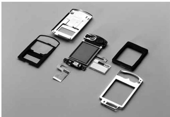
Afbeelding 6. De componenten van een PolyLED-display voor de Sensotec.
