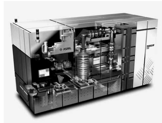
Afbeelding 2. De TWINSCAN van ASML, een wafer stepper met een resolutie van 50 nm.
