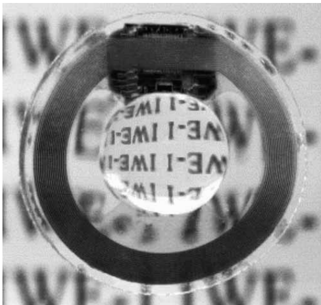
Afbeelding 1. Een intra-oculaire Acri.Tec kunstlens met geïntegreerde druksensor.
