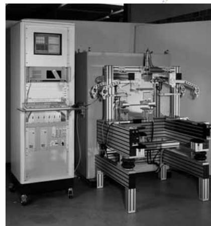
*Atlas Wafer Stage korte slag module kwalificatie-tool, ontwikkeld in opdracht van ASML*
