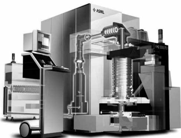
Afbeelding 1. Het ASML-lithografiesysteem PAS 5500 werkend met UV-licht met een golflengte van 365 nm.
