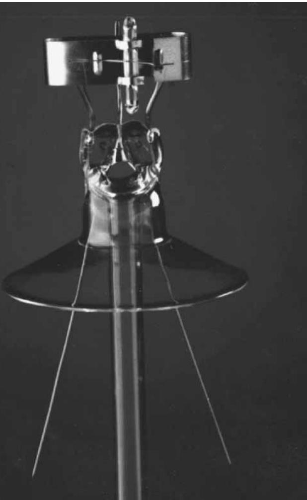
Het 'stel' van de TLD-buis sterker vergroot. Links de aansluitdraden, rechts het glazen buisje met kwik. Dankzij deze zogenaamde kwikpil is de – minimale – kwikdosering nauwkeurig beheersbaar.
