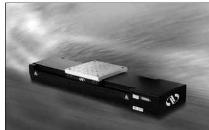
geschiedt door een direct op de spindel gemonteerde encoder met 4000 pulsen per omwenteling. Voor nog hogere precisiedoelen is een lineaire encoder realisierbaar met 0.1 micron increment. Eindschakelaars en nulpuntschakelaar zijn aanwezig alsmede op elastomeren gebaseerde mechanische eindstops.
