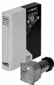
De zwarte doos die de motion controller bevat en een willekeurige DC-motor.
