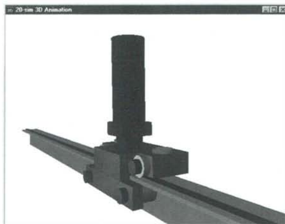
Afb. 5 3D-animatie van de lineaire actuator.
