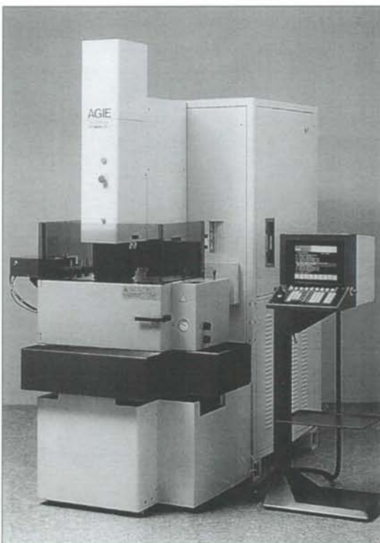
Figuur 3. AGIE Compact I, voorbeeld van één van de weinig middelgrote zinkvonkmachines met microkit voor het allerfijnste zinkvonken. (Foto AGIE)
