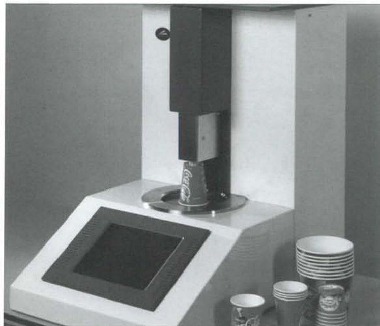
Figuur 1. De bekermeter die door Demcon Twente is ontwikkeld voor Polarcup.
