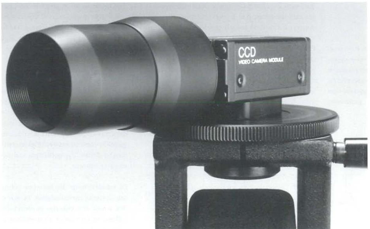
Figuur 10. Het monolithisch teleobjectief geplaatst op een miniatuur CCD-camera.
