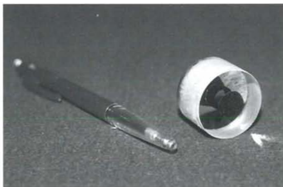
Figuur 6. De monoliet. Dit "ene blokje glas" is een compleet optisch systeem met vier optisch werkzame vlakken: twee sferen, één asfeer en één Schmidt-vlak. Hier afgebeeld naast een balpen.
