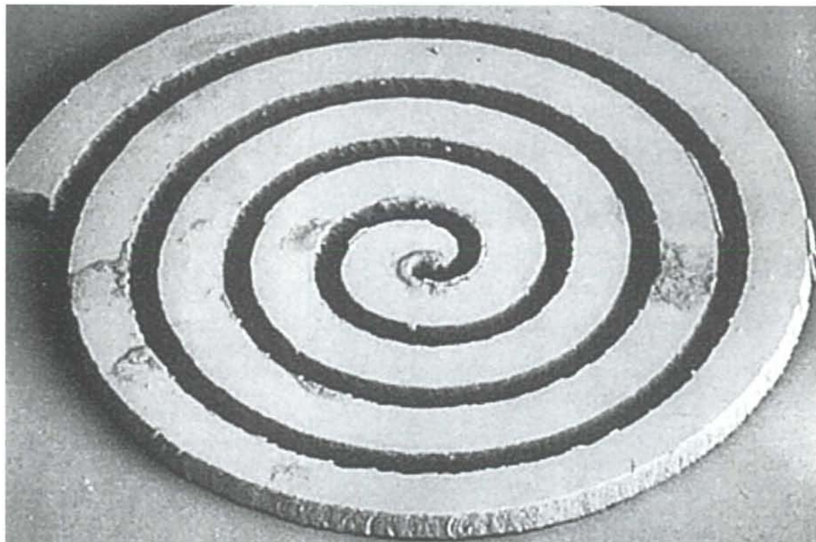
Figuur 11. Met een excimeerlaser gestructureerde glaslenz: afmeting 600 x 600 \mu m . (Afbeelding: Laserzentrum Hannover)
