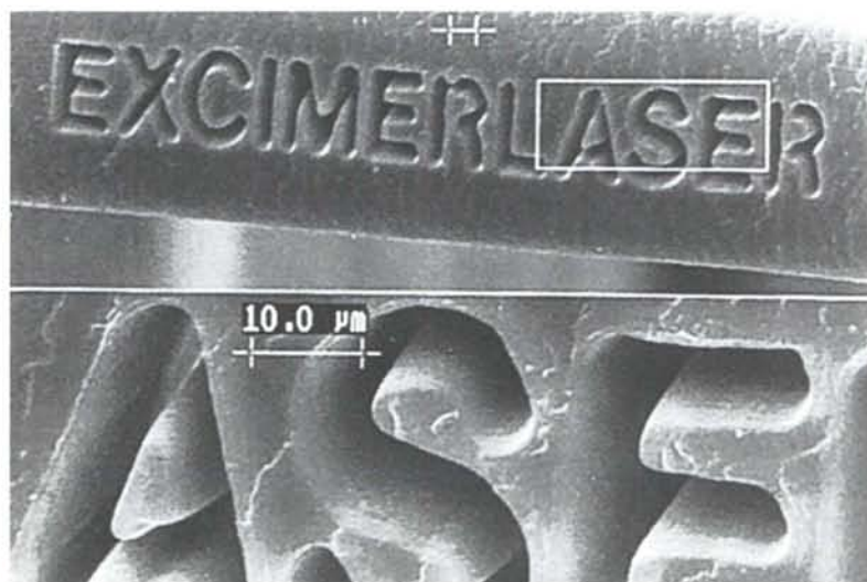
Figuur 3. Demonstratie van de mogelijkheden van de excimeerlaser in de fijn- en micromateriaalbewerking: een menselijke haar, door de excimeerlaser voorzien van tekst. (Afbeelding: Lambda Physik)
