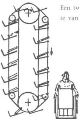
Figuur 1. Structuurschets voor een nieuw te ontwerpen boekenstelling.
