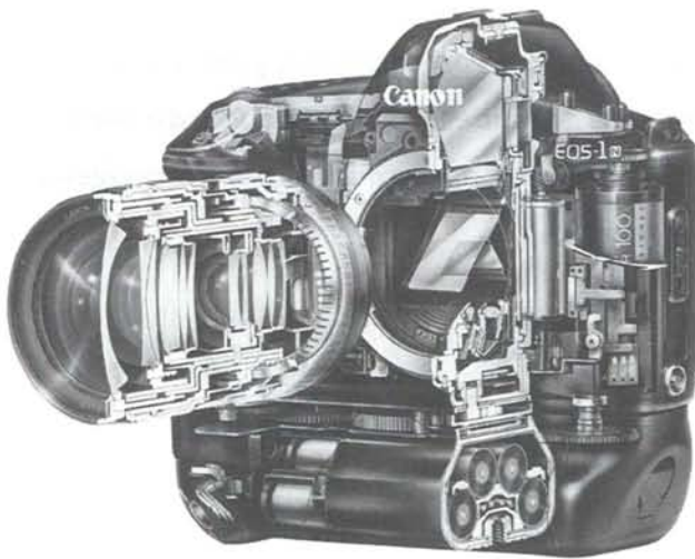
Figuur 2. Opengewerkte tekening van een volledig automatische camera, de Canon EOS 1N.
