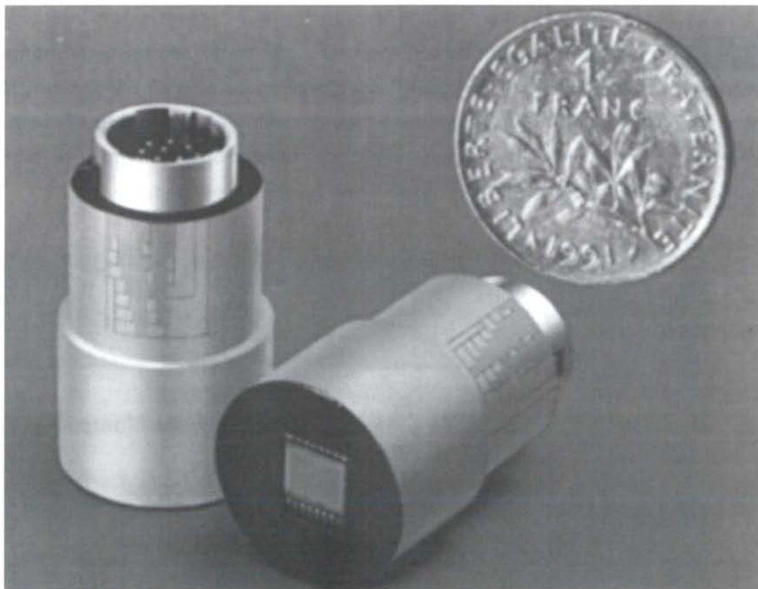
Figuur 3. Microcamera packaged door het gebruik van MCM-V (Het verticale Multi Chip Module proces) van 3D Plus/Thomson- CFS DOL. (Met dank aan 3D Plus, bron MST news 15/96)
