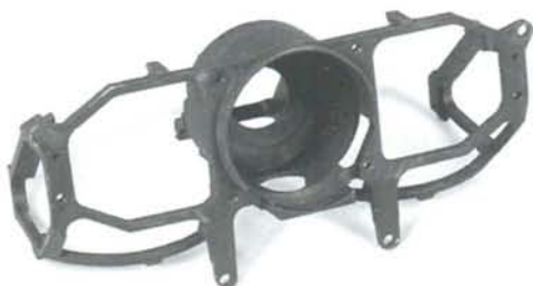
Kijkerframe Speciale spantechnieken zijn nodig om dit fragiele lichtmetalen onderdeel te bewerken en daarbij zeer nauwe toleranties te halen.
