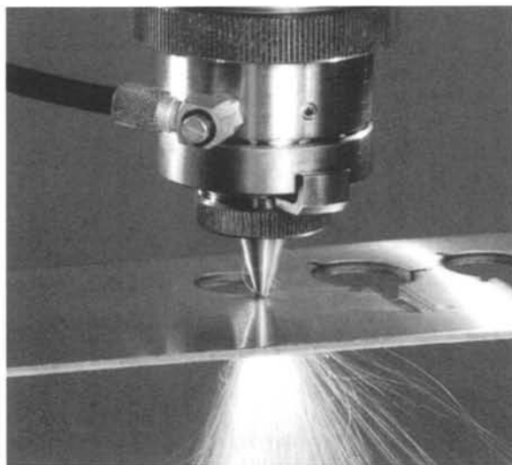
Snijden van CrNi band zonder oxidatie.
