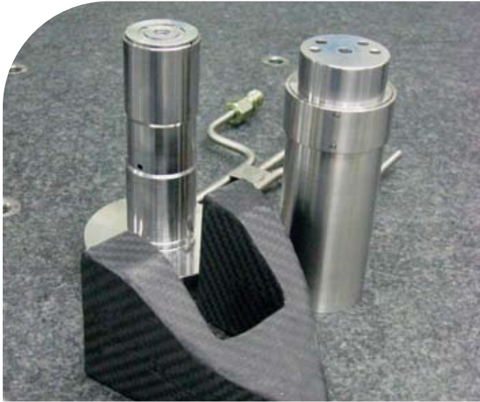
De gereedschapactuator: as en bus van het hydrostatische lager, met daarvoor de carbon fiber gereedschapsarm
