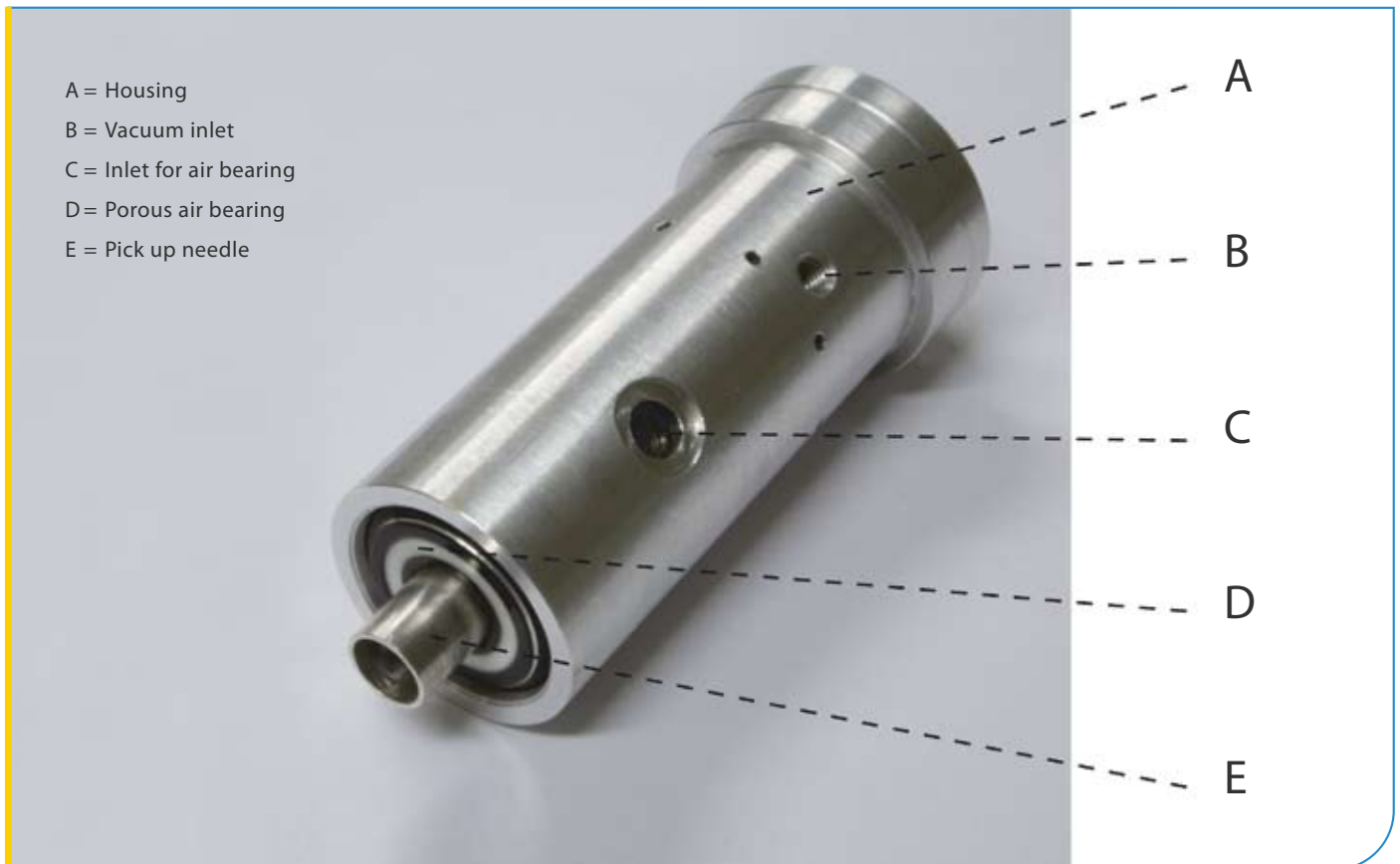
De gripper waarmee een assemblagerobot de joystick op de chip plaatst
