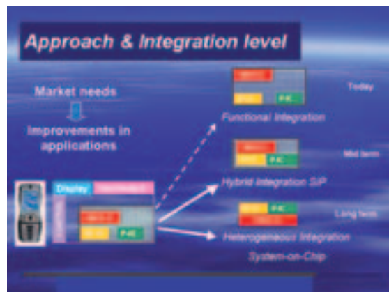
Afbeelding 1. De drie niveaus geven aan op welke wijze de elektro-fotonische integratie kan worden doorgevoerd: functioneel, hybride of heterogeen.
