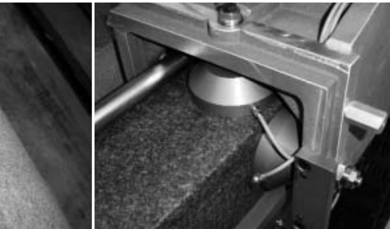
Afbeelding 6. Een luchtlagergeleiding voor de Y-beweging.
