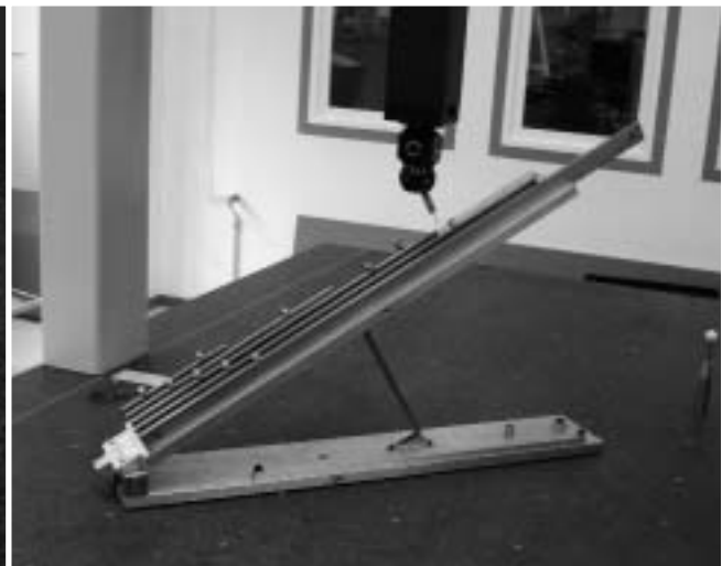
Afbeelding 13. Kalibratie van een meetmachine met Koba meetstandaarden.
