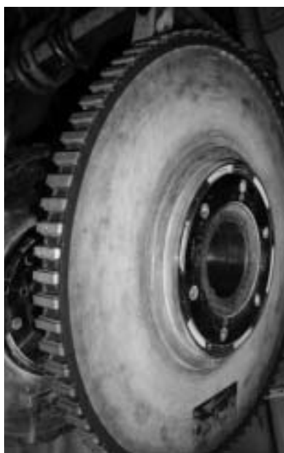
Afbeelding 2. Een slijpsteen met inzetstukken van diamant voor de Waldrich Coburg slijpbank.
