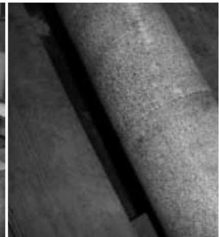
Afbeelding 5. Een tweezijdig uitgeboorde kern van polymeerbeton. Uit de nauwelijks zichtbare overgang in het midden blijkt hoe nauwkeurig de wederzijdse boorgaten in één lijn liggen.
