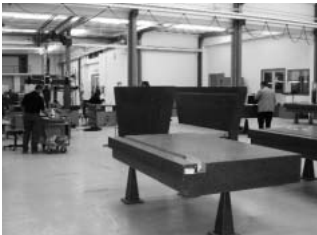
Afbeelding 8. De voormontageruimte. Op de basisplaten zijn duidelijk de luchtlagervlakken voor de Y-beweging te onderkennen.
