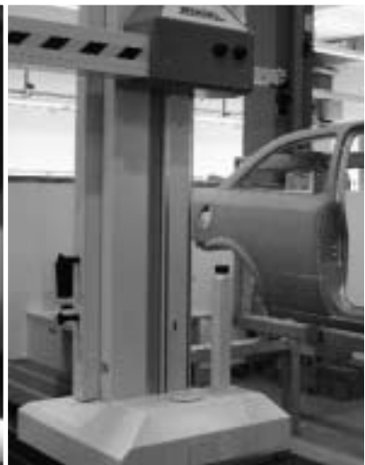
Afbeelding 11. Een staandermeetmachine voor het meten van autobody's.
