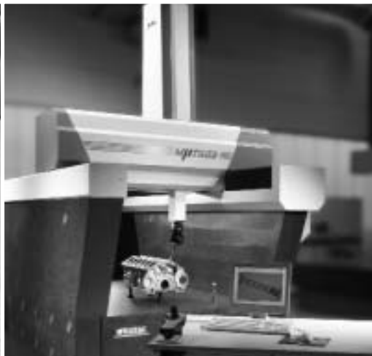
Afbeelding 10. Een Wenzel Mythos meetmachine met een meetgebied van 1000 x 1600 x 800 mm 3 .
