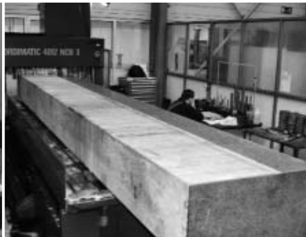
Afbeelding 4. Coördinatenboren van een basisplaat van polymeerbeton op een Edel Koordimatic. Let op het gelepte vlak rechts, voor de luchtlagering in de Y-richting.
