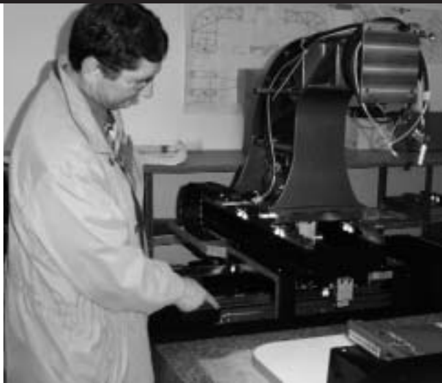
Afbeelding 1. Een Wenzel Smart CMM met hardstenen basisplaat wordt opgebouwd.
