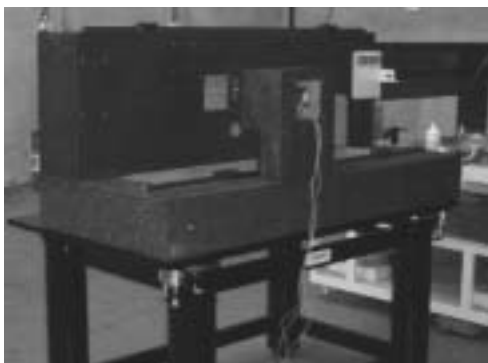
Afbeelding 4. Het frame van Susan heeft dankzij een granieten tafel een hoge stabiliteit en is daarnaast voorzien van actieve, pneumatische trillingsisolatie.
