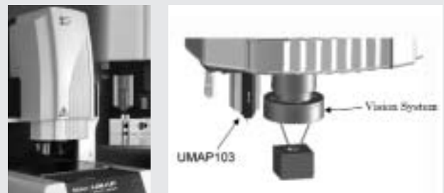
Afbeelding 10. Het UMAP-meetsysteem, met een vision- en een tastkop.
