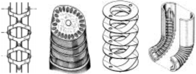
Afbeelding 4 Mechanismen voor colonoscopie. Links: conventioneel, midden links: doorsnede octopusarm, midden rechts: ring-spring-mechanisme, rechts kabel-ring-mechanisme
