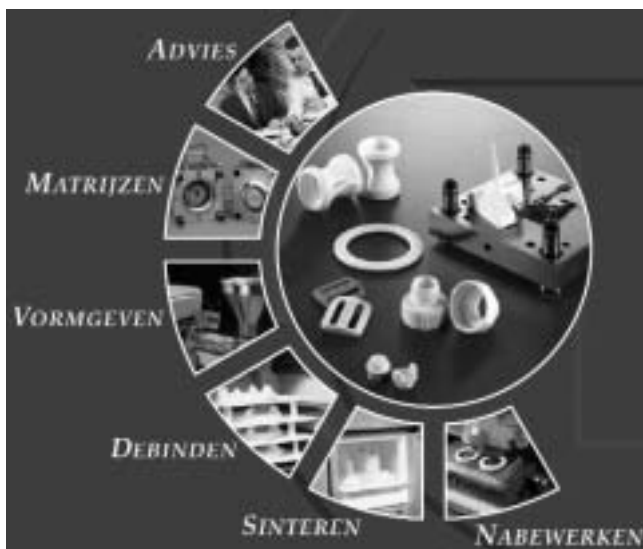
Afbeelding 1. De diverse fasen in het ontwerp- en fabricageproces van Formatec. In de cirkel enkele producten en een matrijs.
