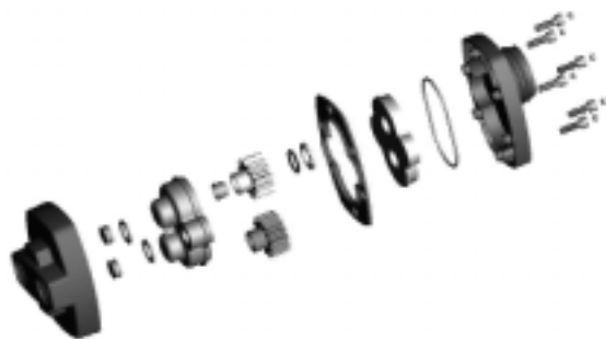
Afbeelding 5. "Exploded view" van een keramische tandwielpompe.
