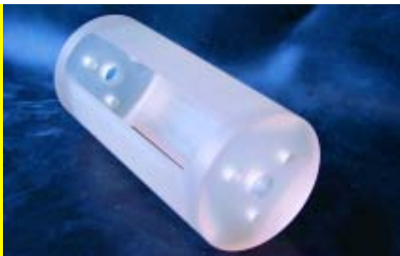
Cavity van de refractometer, gemaakt van Zerodur
