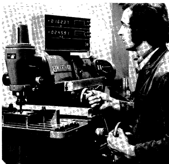
Een Elesta positie-aanwijssysteem, gemonteerd op een freesbank.
