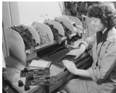
In de montage van radio's bij Philips halverwege de jaren vijftig werken voornamelijk vrouwen. Zij voeren de verschillende fabricage- en montageschappen uit. Boven: Fabricage van de gedrukte bedrading. Midden: Voorbereiding van de onderdelen door alle aansluitdraden gelijktijdig om te buigen zodat ze in de gaten van de montageplaat passen. Onder: Plaatsing van de montageplaat met onderdelen in de knip-buigmachine voor het afknippen en nog een keer ombuigen van de aansluitdraden.
