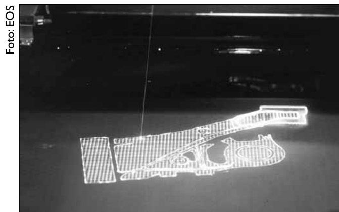
Figuur 1/4. RP geeft door middel van een scannende laserstraal, laag voor laag uithardend, een CAD-model.
