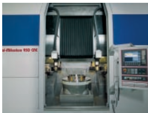
Afbeelding 3. Gereedschapwisseling aan weerszijden draaitafel.
