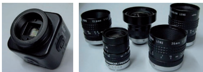
Afbeelding 3. Camera en lenzen voor vision-toepassingen.
