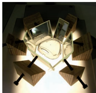
Afbeelding 2. Opstelling voor de inspectie van scheerkappen op defecten.
