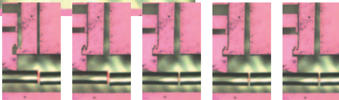
Abbeiding 5. 1D fiberpositioneer- en klem- functie in actie (fiberdiameter 125 \mu\text{m} ).
