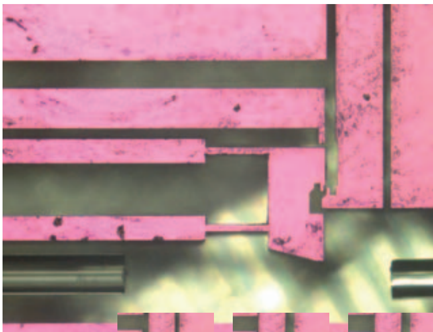
Abbeiding 5. 1D fiberpositioneer- en klem- functie in actie (fiberdiameter 125 \mu\text{m} ).
