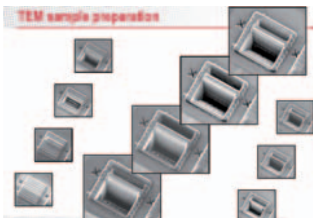
Afbeelding 21. Het maken van een TEM-preparaat met een DualBeam. Na observatie met de SEM wordt van een interessant gedeelte een lamel ter dikte van 100 nm met de ionenbundel uitgesneden.
