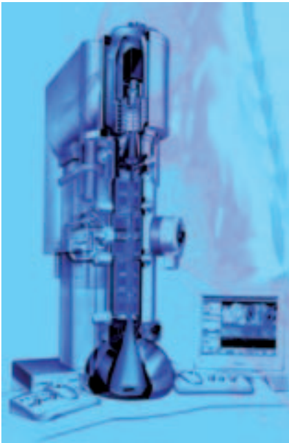
Afbeelding 5. Schematische doorsnede van de kolom van een transmissie-elektronen-microscop.
