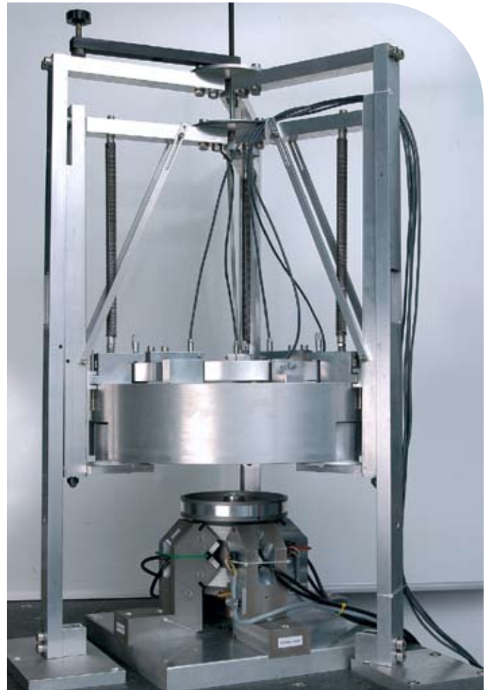
Het metrologieframe, hangend aan slappe veren. Hier nog boven de rotor; tijdens de experimenten hangt de ring over de rotor en stator heen
