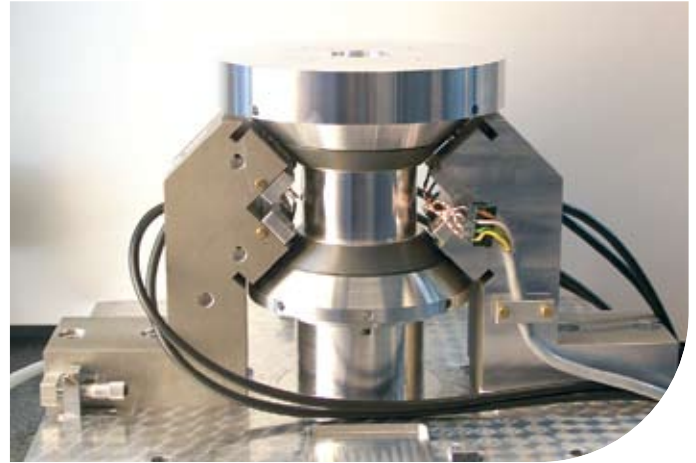
De rotor op het moment dat de actuatoren (met grijze draden) en optische sensoren (met zwarte draden) precies worden uitgelijnd ten opzichte van de rotor
