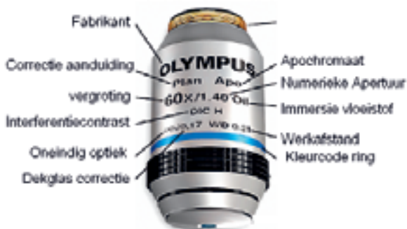
Afbeelding 8. Betekenis van de opschriften op een objectief.
