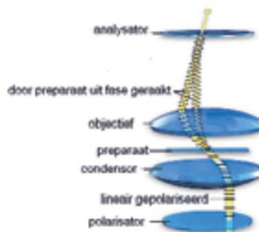
Afbeelding 13. Het ontstaan van polarisatiecontrast bij doorvallend licht.
