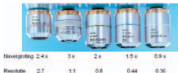
Afbeelding 10. Objectieven met daaronder de factor voor navergroting die nog juist een zinvol beeld oplevert. Onderste regel: het haalbare scheidend vermogen in \mu\text{m} .
