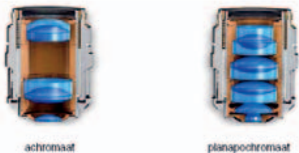
Afbeelding 7. Doorsneden van een achromaat en een planapochromaat.
