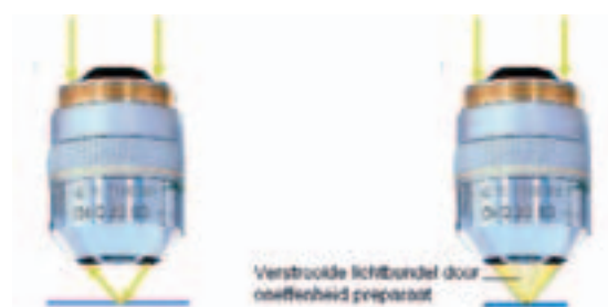
Afbeelding 12. Links: donkerveld-contrast ontstaat door het licht onder een hoek kleiner dan 90^\circ op het object te laten vallen. Rechts: verstrooiing van de bundel.
