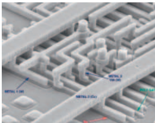
Afbeelding 1. Typische opbouw van een IC, kleinste lijnbreedtes liggen hier in de orde van 200 nm.
