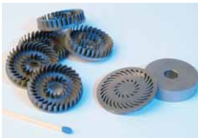
Afbeelding 4. Links enkele met PEM gemaakte turbinewielen. In het midden de elektrode, rechts het uitgangsmateriaal.
