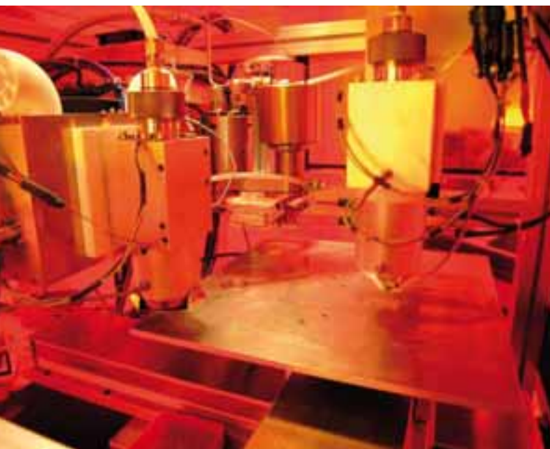
Afbeelding 6. Opstelling voor het inkjetprinten van polymere halfgeleiders.
