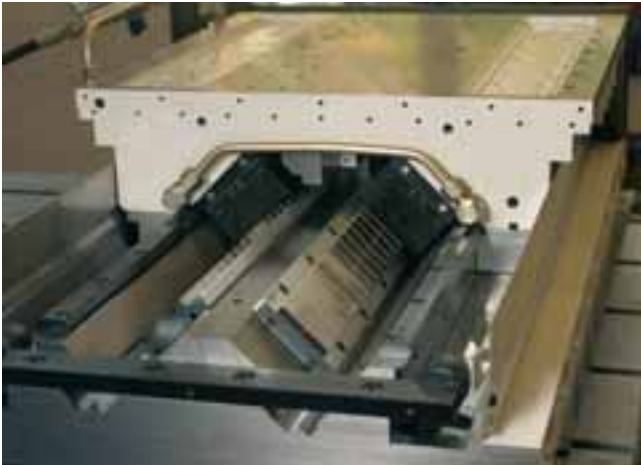
Figuur 7. Lineairmotor met geïntegreerde hydrostatische lagering en geleiding.
