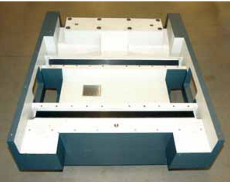
Figuur 2. Bed van een precisieslijpbank gegoten uit Granitan S 103.
