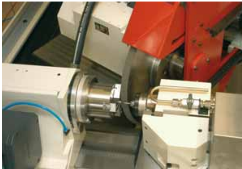
Figuur 5. Simultaan binnen- en buitenslijpen is mogelijk.
