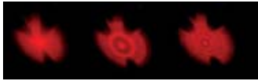
Figuur 9: Foto's van het verlichtingspatroon op een scherm dat voor een lens gehouden wordt die met verschillende frequenties aangestuurd wordt: (links) 0 Hz, (midden) 25 Hz, (rechts) 50 Hz. De ringen worden veroorzaakt door interferentiepatronen op het grensvlak.
