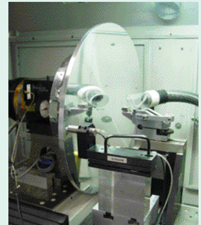
Figuur 9: LVDT vormmeting met intensiteit analyse C2 spiegel
