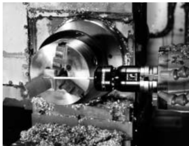
Afbeelding 3. Inzet van een MP700 tastersysteem met optische signaaloverdracht bij het in de machine meten van een werkstuk (schoep). Een dergelijk systeem is geschikt voor automatische instelling en controle van het werkstuk tijdens het bewerkingsproces.
