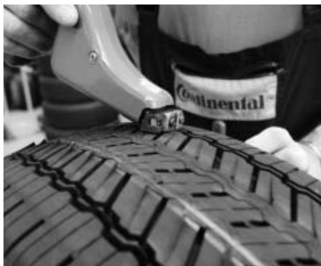
Afbeelding 4. Een prototype band wordt met de hand gesneden.
