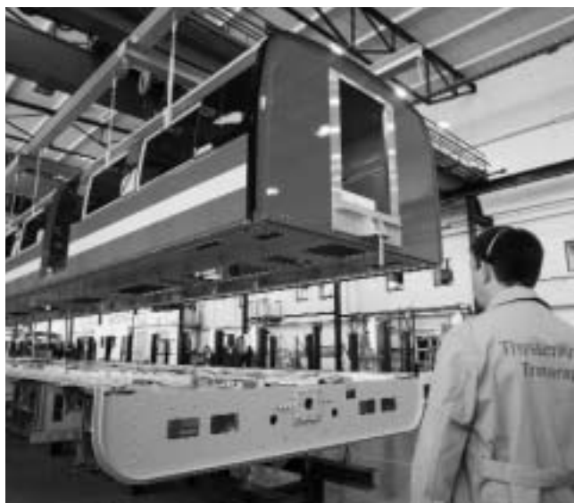
Afbeelding 5. De carrosserie van de Transrapid wordt op het chassis getakeld.
