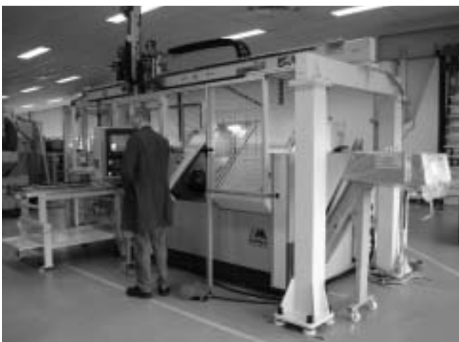
Afbeelding 3. Geautomatiseerde cel rondom horizontale Mikroturn ultraprecisiemachine.
