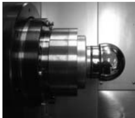
Afbeelding 1. Hoogglansdraaien van een koperen bol.
