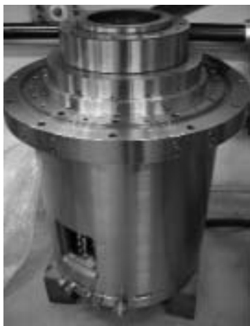
Afbeelding 6. Hoofdasconstructie van de draaitafel met torquemotor.
