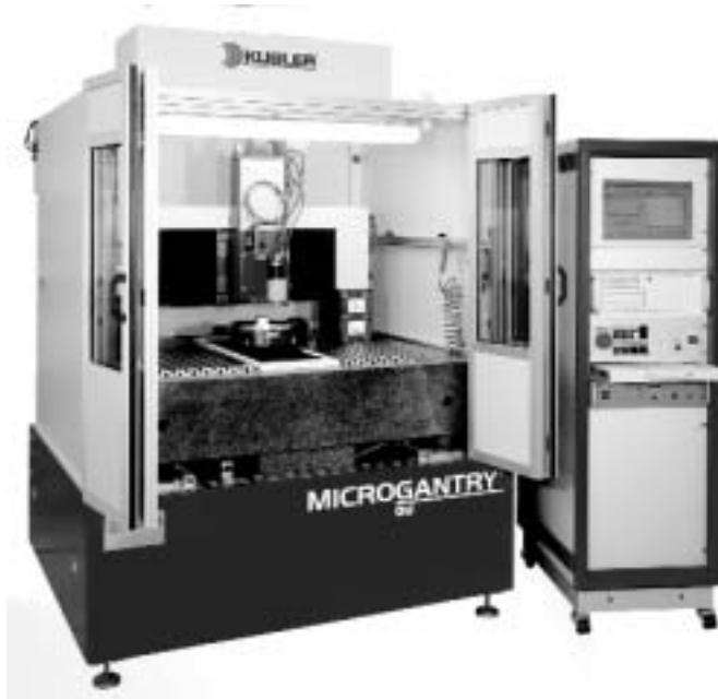
Afbeelding 1. Het precisiebewerkingscentrum Microgantry GU is geschikt voor conventioneel metaalbewerken en lasermicrobewerken en -structureren.
