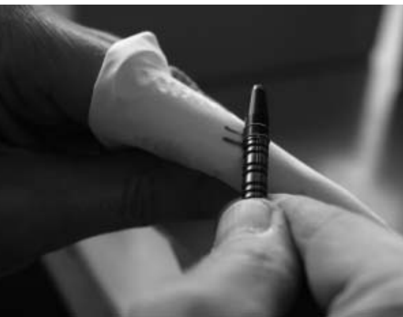
Afbeelding 2. Verwijderen van lijmresten na het aanbrengen van de kleurcodering op een handvat van titaan.
