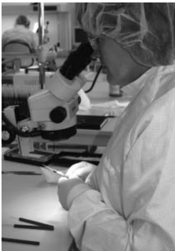
Afbeelding 8. Montage van ooginstrumenten in een stofarme ruimte.
