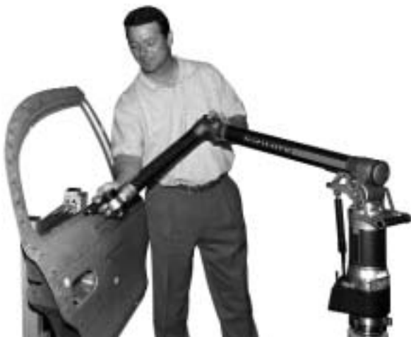
Afbeelding 5. Een meetarm, hier de Infinite van het Amerikaanse CimCore, is erg geschikt voor het meten van autocomponenten.
