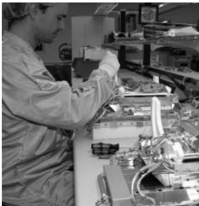
Afbeelding 3. Montage van een SEM-preparaattafel voor FEI Company in een stofarme ruimte van Frencken Mechatronics.
