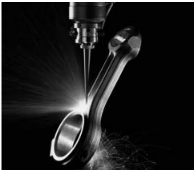
Afbeelding 4. Laserboren van een schuin smeergat in een drijfstang met een Trumpf laserboor- en -snijmachine HL 101 P.
