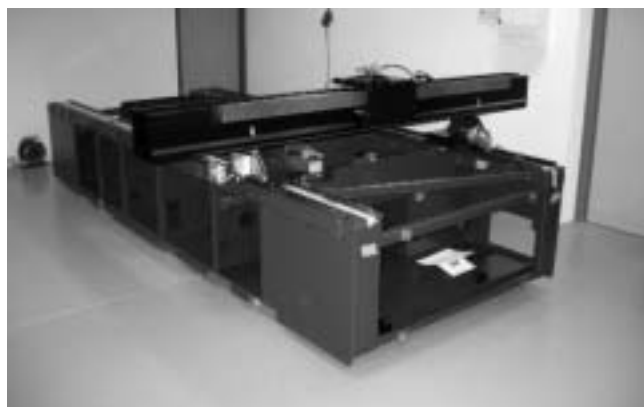
Afbeelding 1. Machineframe van BoTech met lineaire motoren en geleidingen van Anorad Europe voor een digitale inkjetprinter.
