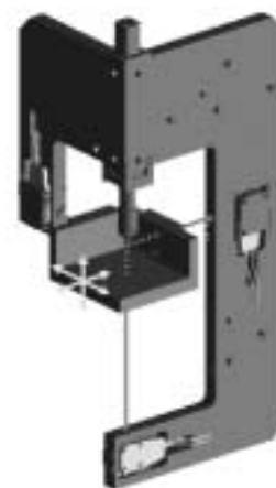
Afbeelding 7. De ISARA UP coördinatenmeetmachine (ontwerp: Theo Ruij).
